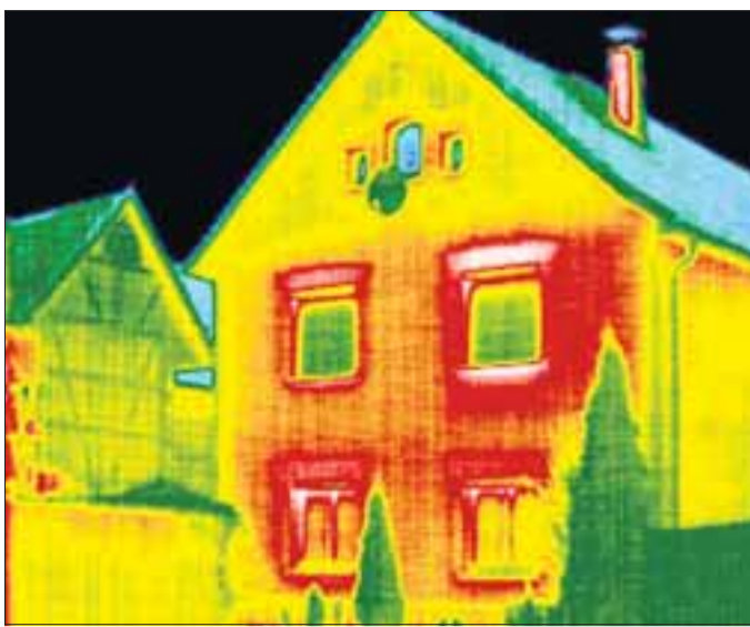
WOHNHAUS: Die Wärmebildkamera macht Energieverluste durch ungedämmte Außenwände sichtbar.
