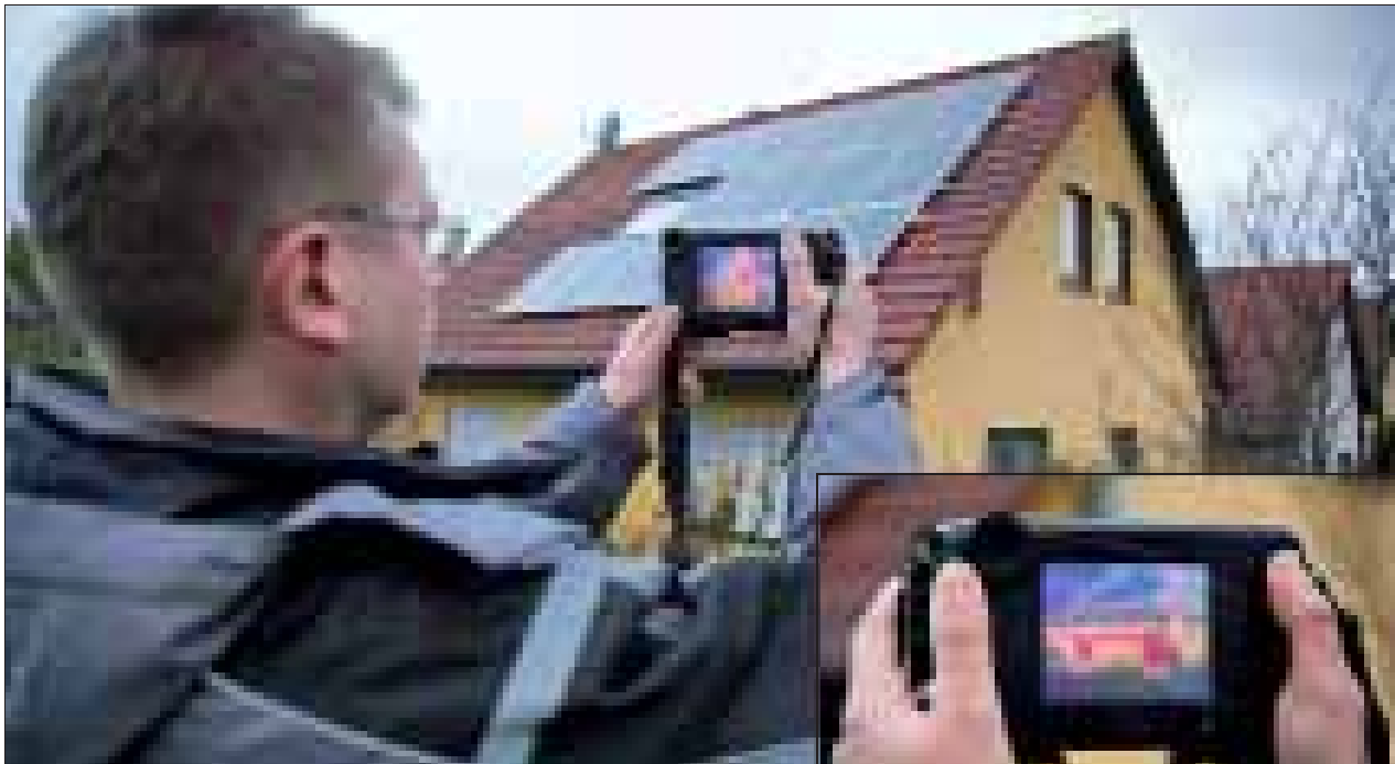
INTELLIGENTES FOTOSHOOTING: Lutz Weidners Spezialkamera macht Wärmeschlupflöcher sichtbar.
